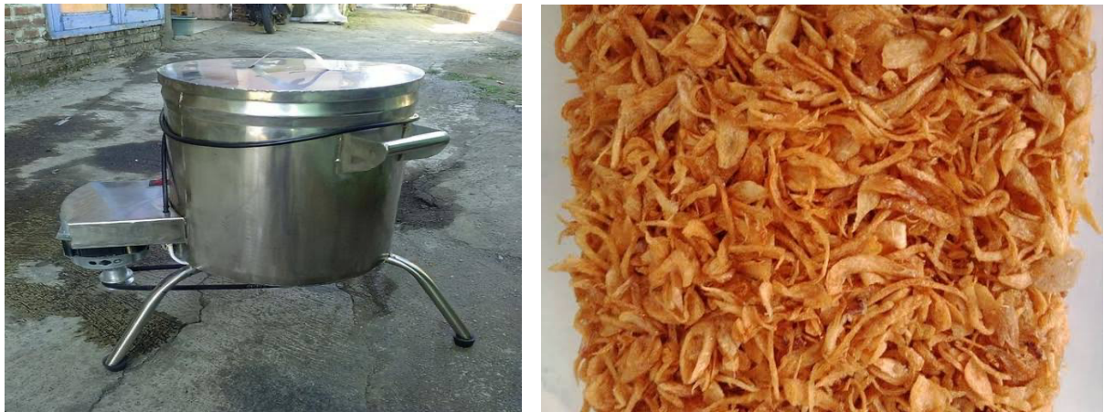
Gambar 2 Pengeringan Bawang Goreng Menggunakan Mesin Spinner
